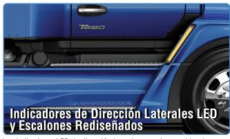
Los indicadores LED de dirección lateral, montados en el borde sobresaliente del guardafango, aumentan la visibilidad para el tráfico circundante. Los escalones permiten un mejor acceso a la cabina.
